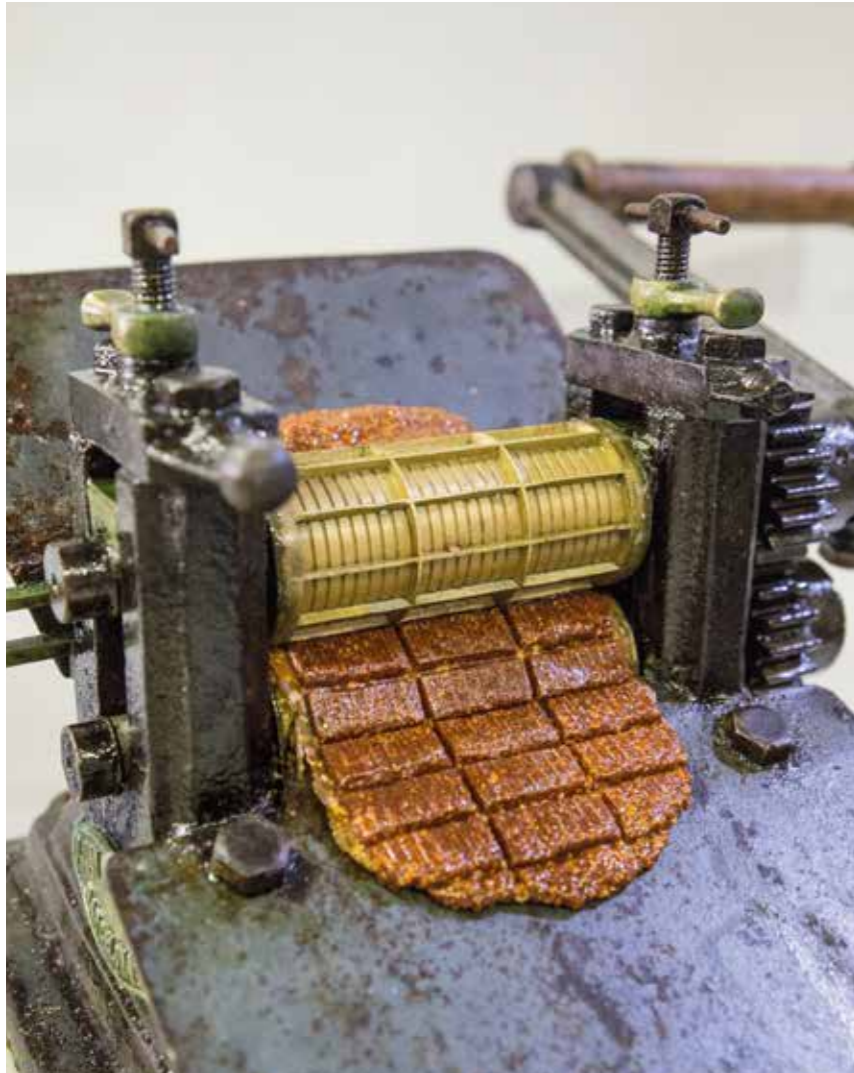
MÁQUINA PARA ELABORAR LOS CARAMELOS DE GUIRLACHE. CONFITERÍA EL ÁNGEL.
